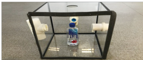
혼증하고자 하는 증거품을 챔버에 넣은 후 각 모듈을 챔버에 부착시켜 시스템을 가동한다.
